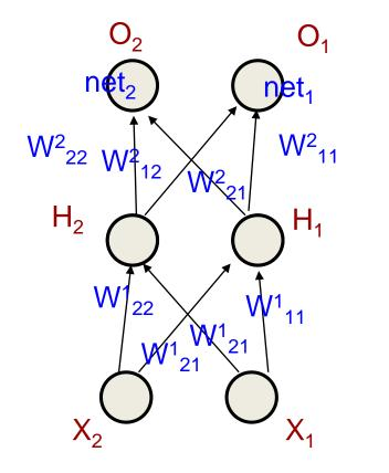
$$E = -t_2 \log o_2 - t_1 \log o_1$$
