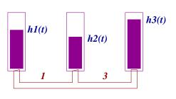
$$h3(t) \qquad \begin{bmatrix} dh_1/dt \\ dh_2/dt \end{bmatrix} = \begin{bmatrix} -1 & 1 \\ -2 & -7 \end{bmatrix} \begin{bmatrix} h_1 \\ h_2 \end{bmatrix} + \begin{bmatrix} 0 \\ 3H \end{bmatrix}$$
