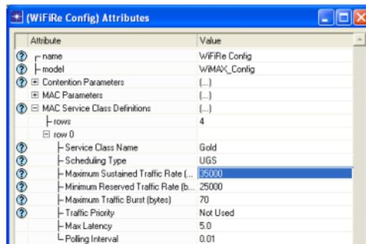
Figure: UGS parameters
